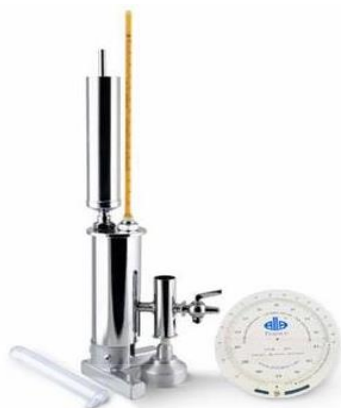
ภาพที่ 2.7 ลักษณะของเครื่องอีบูลิเมเตอร์(Ebulliometer)
