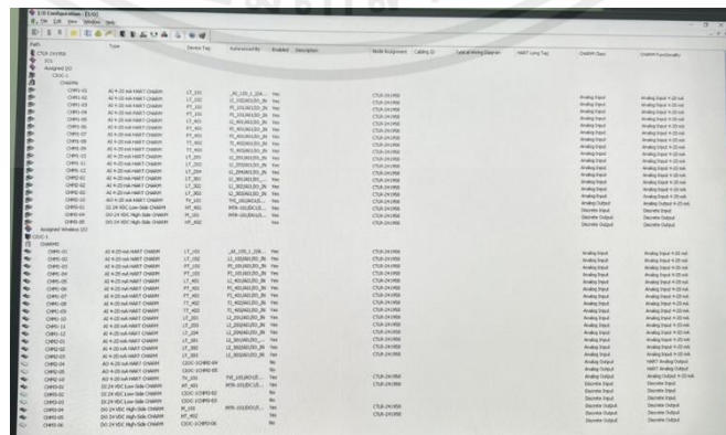
รูปที่ 3.7 แสดงหน้าโปรแกรม I/O Configuration
