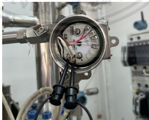
รูปที่ 3.20 แสดงการเกี่ยวหัวคลิปโพรบมิเตอร์กับอุปกรณ์วัด
