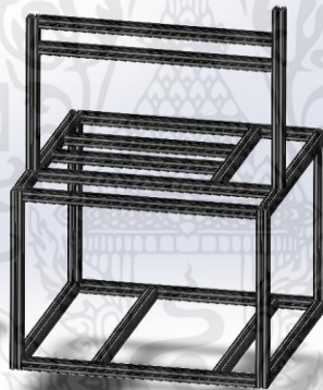
รูปที่ 3.2 โมเดลโครงอลูมิเนียมโปรไฟล์
