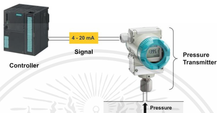
รูปที่ 2.10 ส่วนประกอบที่จำเป็นต่อ Pressure Transmitter
