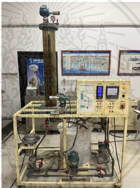
รูปที่ 4.2 Level Control Plant
