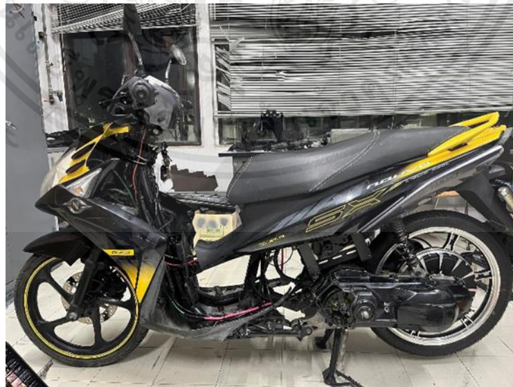
รูปที่ 3.41 ประกอบโครงสร้างภายนอกของตัวรถจักรยานยนต์
