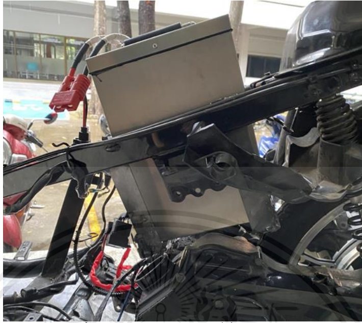
รูปที่ 3.36 ช่องใส่แบตเตอรี่ที่เสร็จสมบูรณ์
