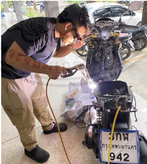
รูปที่ 3.35 การเชื่อมเหล็กที่ได้ทำการตัดเข้ากับโครงรถเดิมเพื่อ U-box ใส่แบตเตอรี่
