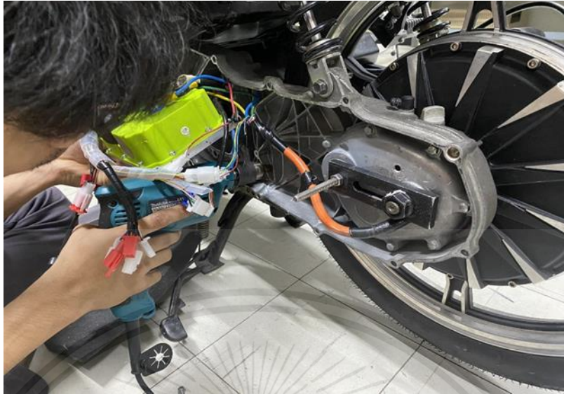
รูปที่ 3.32 เจาะรูเพื่อติดตั้งกับกล่องคอนโทรลเลอร์
