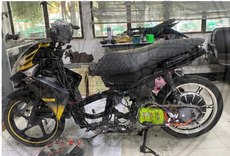
รูปที่ 3.33 คอนโทรลเลอร์ที่ติดตั้งกับชุดช่างที่สมบูรณ์
