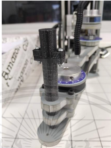
รูปที่ 3.39 ติดตั้งปอกปากกากับแขนกลSACARA Robot 4DOF
