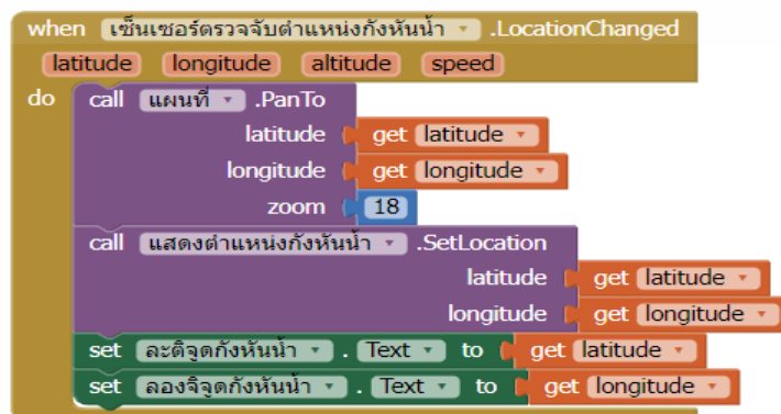
รูปที่ 3.39 บล็อกเซ็นเซอร์ตรวจจับตำแหน่งกังหันน้ำ
