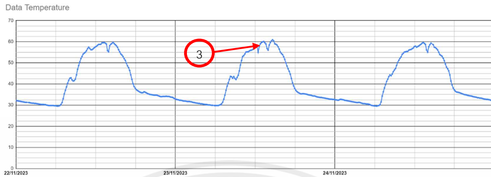
รูปที่ 4.14 กราฟค่าอุณหภูมิภายในโรงอบแห้งในการทดลองขณะเปิดการควบคุม
