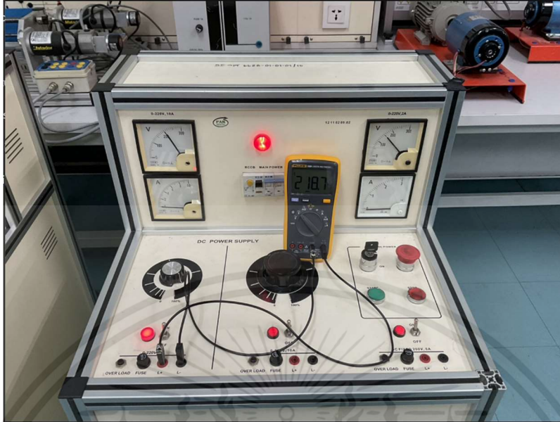
รูปภาพที่ 4.10 การทดสอบพาวเวอร์ซัพพลายกระแสตรงที่สามารถทำงานได้สมบูรณ์
