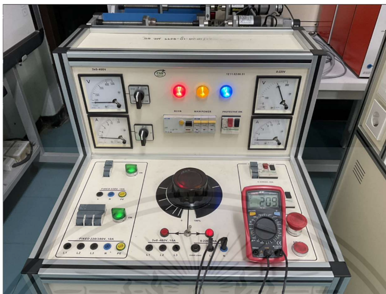
รูปภาพที่ 4.9 การทดสอบพาวเวอร์ซัพพลายกระแสสลับที่สามารถทำงานได้สมบูรณ์
