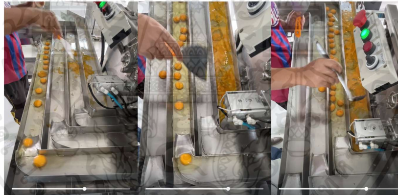
รูปที่ 4.4 การทดสอบคุณภาพไข่หลังจากการตอก
