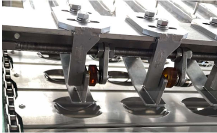
รูปที่ 3.146 ชุดกดไข่ประกอบเสร็จ
