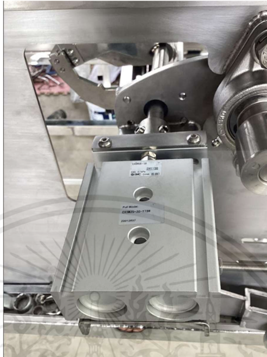
รูปที่ 3.130 ติดตั้งกระบอกลมกับก้านกระบอกลำหรับยึดกับก้านเพลา
