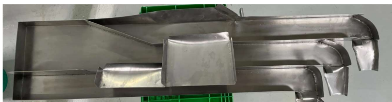
รูปที่ 4.9 รางรับไข่แบบที่ 2 ที่ใช้ในการทดสอบครั้งที่ 2
