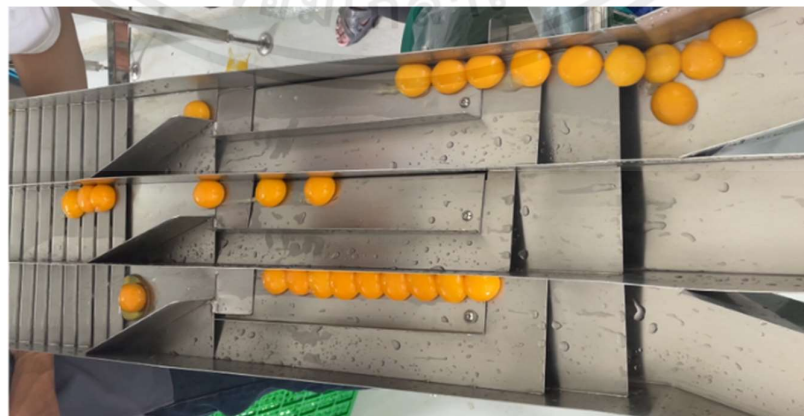
รูปที่ 4.5 การทดสอบฟังก์ชันการแยกไข่
