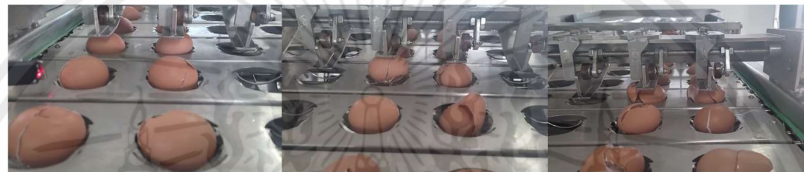
รูปที่ 4.3 การทดสอบฟังก์ชันการกดไข่และการตอกไข่
