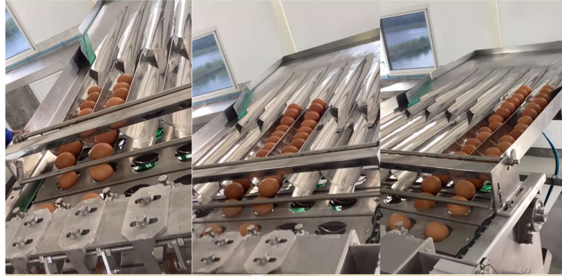
รูปที่ 4.2 การทดสอบฟังก์ชันกดใส่ไข่และก้านเรียงไข่
