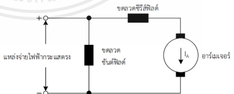
รูปที่ 2.12 วงจรมอเตอร์ Long Shunt Compound Motor
