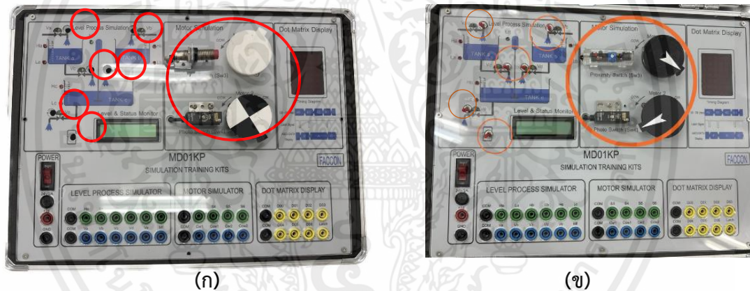
รูปที่ 3.3 แสดงชุดฝึก MD01KP ก่อน และหลังการซ่อมบำรุงเซนเซอร์ที่ชำรุดและแผ่นงานหลักที่เสียหาย
