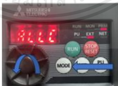
รูปที่ 5 ขั้นตอนการตั้งค่า INVERTER แบบ Digital
