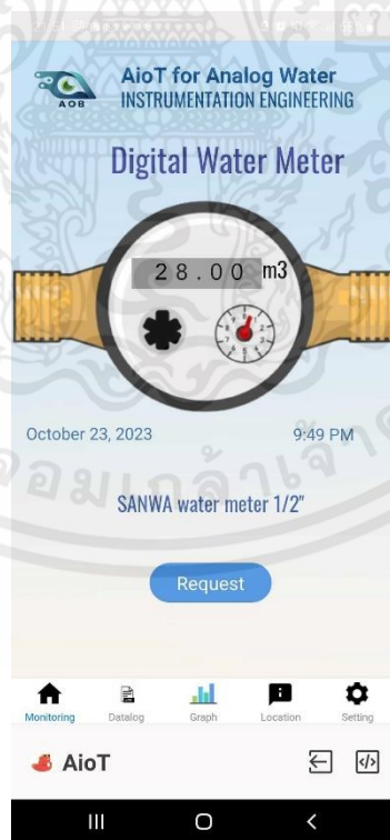
รูปที่ 4.5 แสดงผลมอนิเตอร์บนแอปพลิเคชัน (โทรศัพท์มือถือ)
