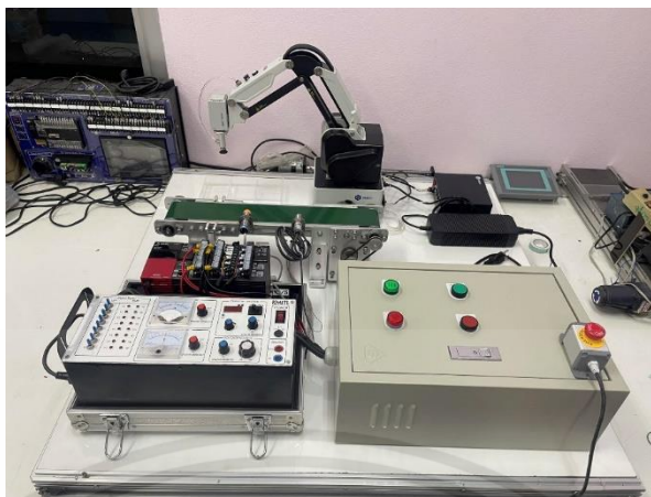
รูปที่ 3.15 โครงสร้างที่สำเร็จรูปแล้วของระบบควบคุมสายพานลำเลียง และแขนกลอัตโนมัติด้วยพีแอลซี
