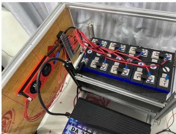
รูปที่ 3.4 การติดตั้ง BMS เข้ากับโมดูลแบตเตอรี่
