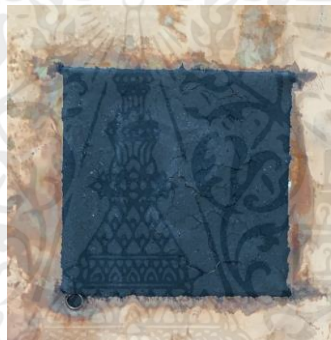
รูปที่ ก.5 อิเล็กโทรดหลังจากแช่สารละลายโพแทสเซียมไฮดรอกไซด์ (KOH) ความเข้มข้น 1 \text{ M} เป็นเวลา 30 นาที และนำไปอบในตู้อบสุญญากาศที่ 60 \text{ }^{\circ}\text{C} เป็นเวลา 1 ชั่วโมง
