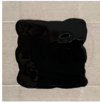
รูปที่ ก.2 ปาดสารละลายอิเล็กโทรดลงบนแม่พิมพ์ให้มีขนาด 5 \times 5 \text{ cm}^2
