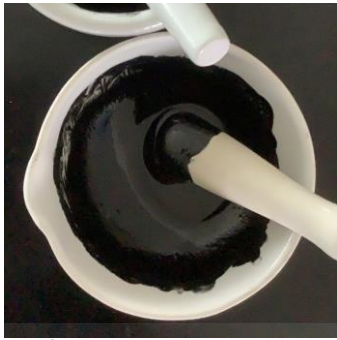
รูปที่ ก.1 PVDF NMP และถ่านกัมมันต์ ผสมให้เข้ากันด้วยโกร่งบดสาร จนได้สารละลายอิเล็กโทรด
