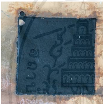
รูปที่ ก.4 อิเล็กโทรดหลังจากอบในตู้อบสุญญากาศที่ 60 \text{ }^{\circ}\text{C} เป็นเวลา 1 ชั่วโมง
