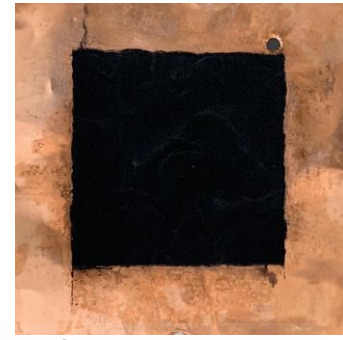
รูปที่ ก.3 สารละลายอิเล็กโทรดหลังจากอบในเตาอบ 100 \text{ }^{\circ}\text{C} เป็นเวลา 1 ชั่วโมง ได้แผ่นอิเล็กโทรด
