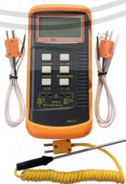
รูปที่ 3.8 อุปกรณ์วัดอุณหภูมิเมล็ดข้าวเปลือกงอก
