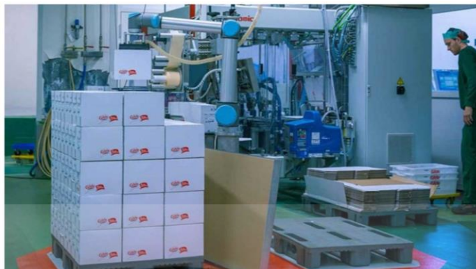
รูปที่ 2.31 ตั้งโคบอท UR10 ที่ติดตั้งกับกริปเปอร์สุญญากาศ
