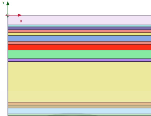
รูปที่ 3.21 รูปแสดงการแบ่งชั้นดินออกเป็นแต่ละชั้นและใส่ค่าคุณสมบัติต่าง ๆ ลงในชั้นดิน
