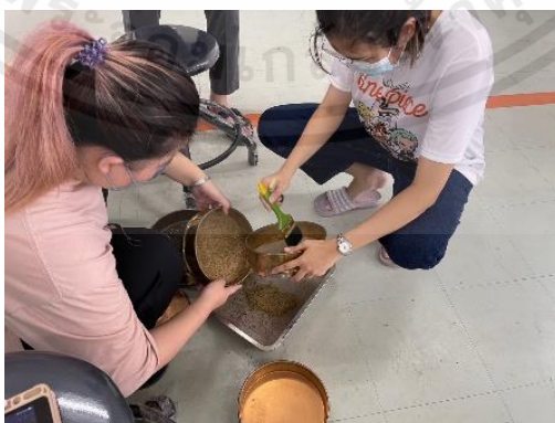
รูปที่ 3.6 การนำดินที่ค้างอยู่บนตะแกรงออกทิ้งและทำความสะอาดตะแกรง
