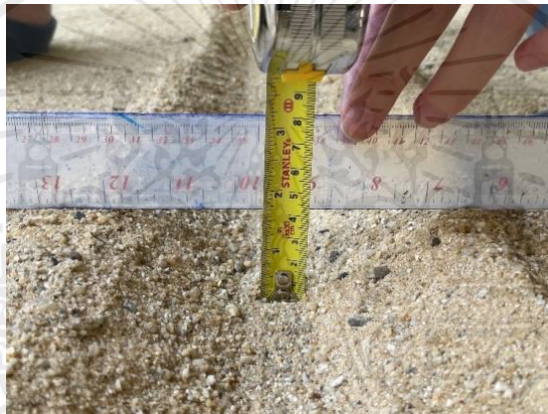
รูปที่ 3.20 วัดค่าความลึกของร่องล้อ
