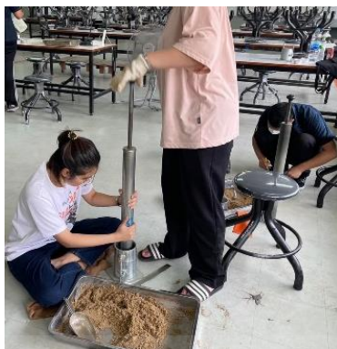
รูปที่ 3.9 การบดอัดดินชั้นละ 25 ครั้ง
