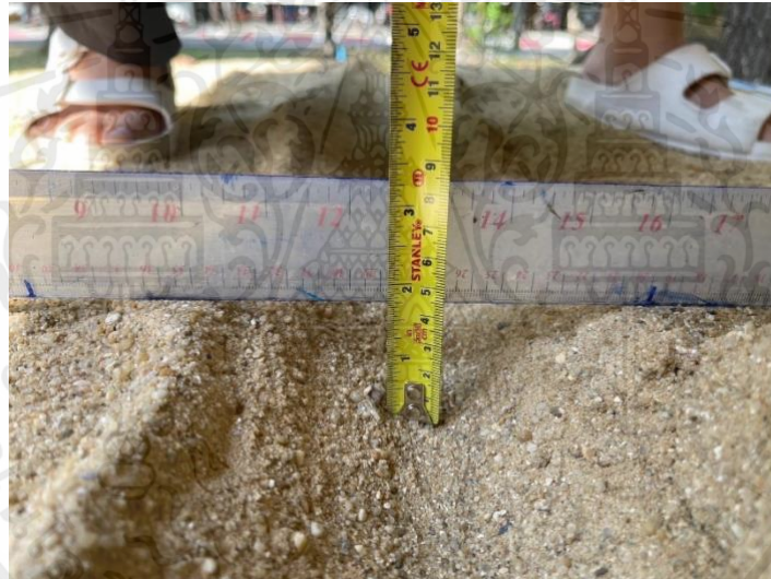
รูปที่ 4.19 การวัดค่าการทรุดตัวสุดท้ายในบริเวณที่เสริมกำลังด้วยแผ่นยางคอมพาวด์
