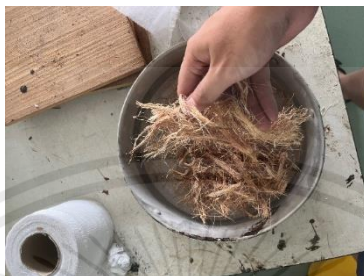
รูปที่ 3.1.2 เส้นใยจากกาบมะพร้าวหลังอบ
