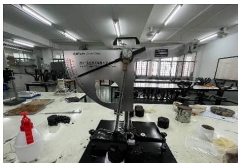
รูปที่ 2.3.4 เครื่องมือทดสอบการต้านทานการลื่นไถล
