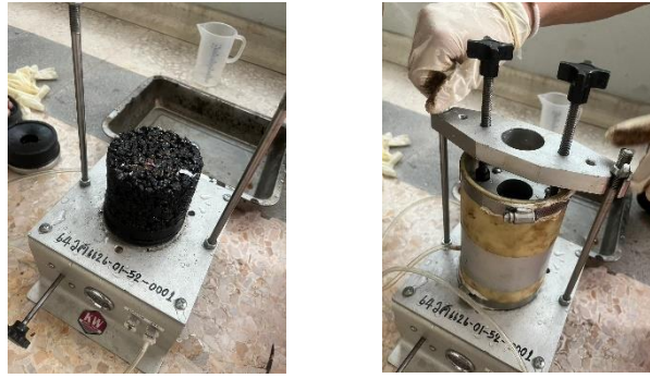
รูปที่ 3.3.1 การติดตั้งอุปกรณ์และตัวอย่างในการทดสอบการซึม
