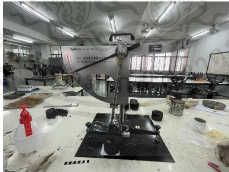
รูปที่ 3.3.4 แสดงค่าความต้านทานบนอุปกรณ์ BPM
