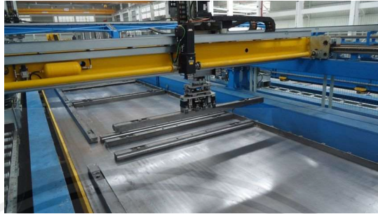
รูปที่ 2.9 การวางเหล็กกันแบบ (Pruksa Real Estate, 2015)
