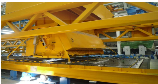
รูปที่ 2.11 การวางตำแหน่งอุปกรณ์และของฝัง (Pruksa Real Estate, 2015)
