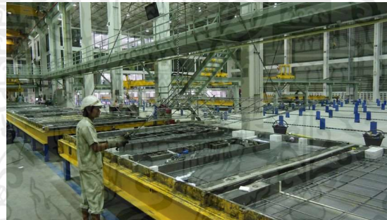
รูปที่ 2.10 การวางตำแหน่งอุปกรณ์และของฝัง (Pruksa Real Estate, 2015)
