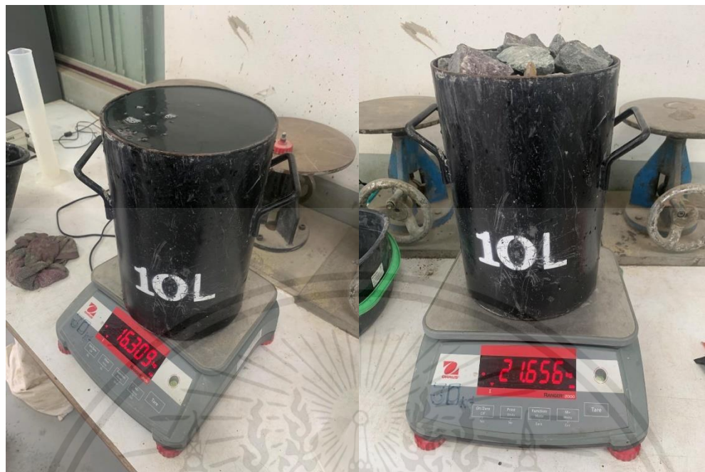
ภาพผนวกที่ ก5 การทดสอบการดูดซึ่มของมวลรวมหยาบ
