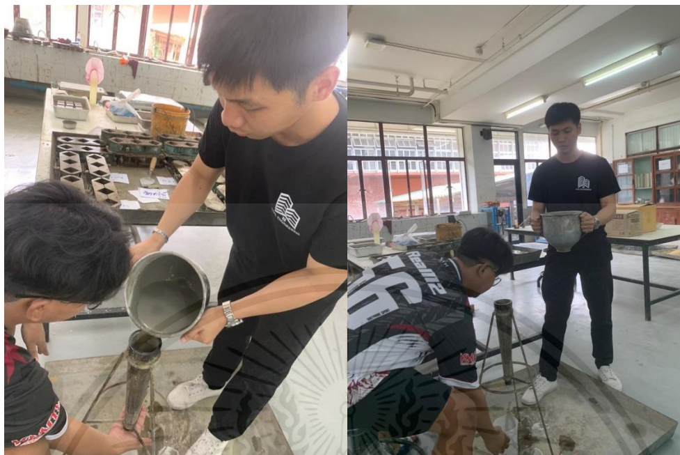
ภาพผนวกที่ ก11 ทดสอบการไหลในแนวดิ่ง (j-funnel)
