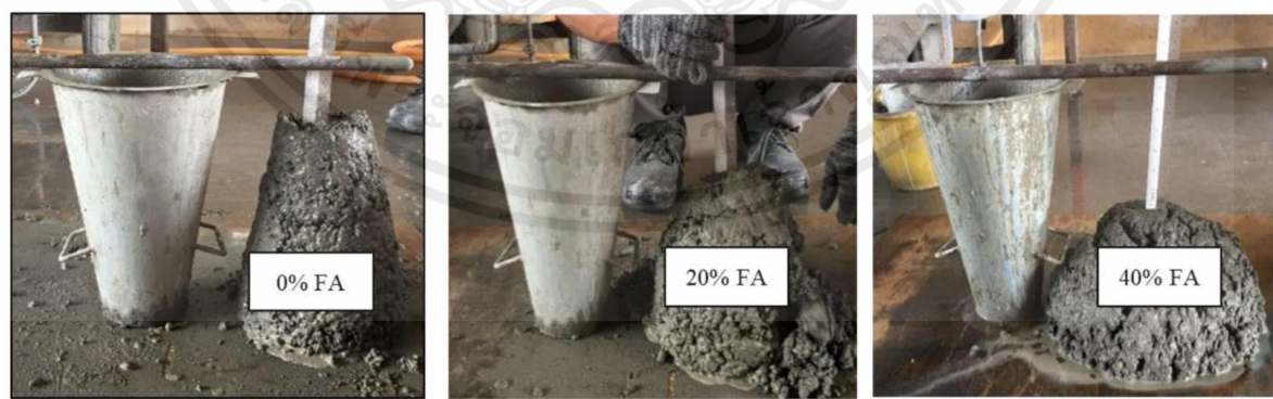
รูปที่ 2.6 รูปแสดงการเปรียบเทียบระหว่าง ใส่เถ้าลอยที่ 0%,20%,40%
