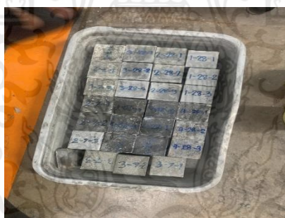
รูปที่ 3.19 ทดสอบหาค่ากำลังรับแรงอัด
