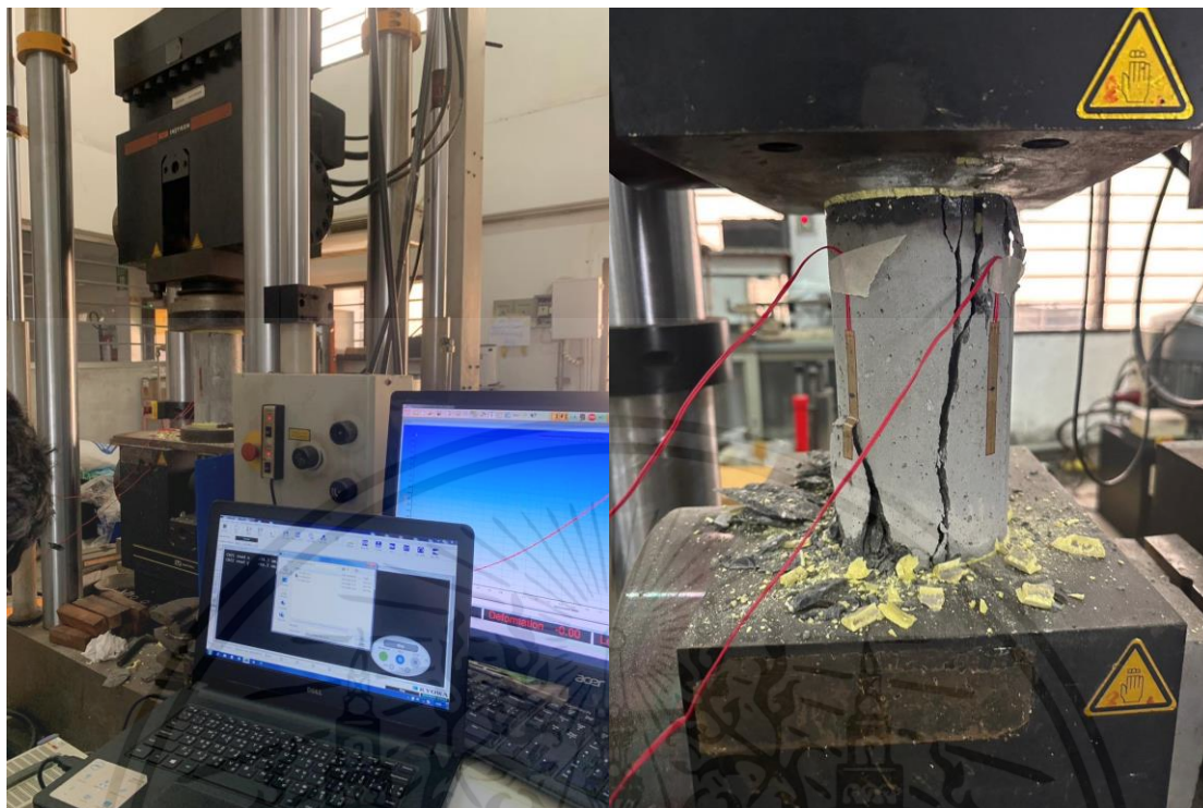
ภาพผนวกที่ ก13 การทดสอบหาค่าโมดูลัสความยืดหยุ่น
