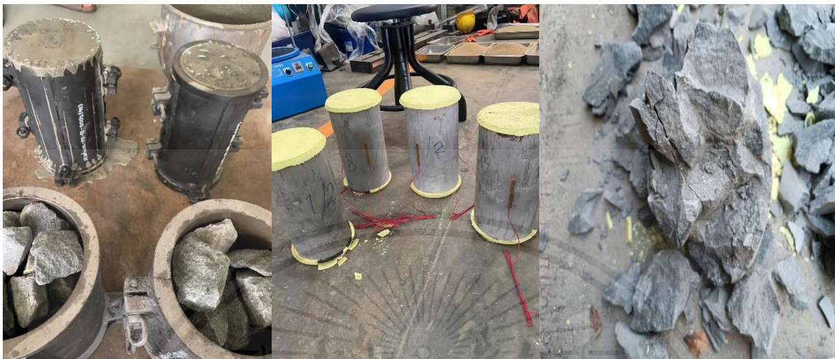
ภาพผนวกที่ ก15 การทดสอบหาค่าโมดูลัสความยืดหยุ่น
