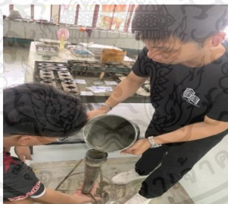
รูปที่ 3.13 ทดสอบความหนืดของมอร์ตาร์
