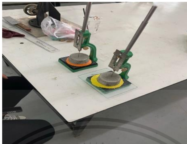
รูปที่ 3.16 ทดสอบหาค่าการก่ตัวของมอร์ตาร์
