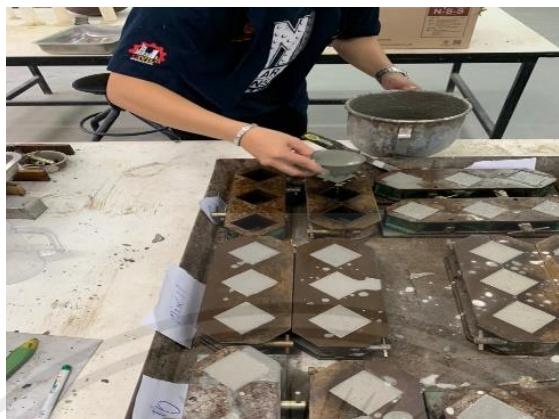
รูปที่ 3.18 ทดสอบหาค่ากำลังรับแรงอัด
