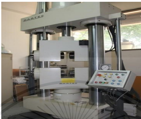
รูปที่ 3.20 เครื่องมือการทดสอบหาค่าโมดูลัสความยืดหยุ่น
