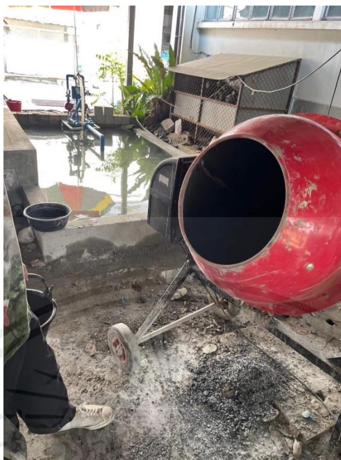
ภาพที่ 23 ผสมตัวอย่างทดสอบในโมผสม
