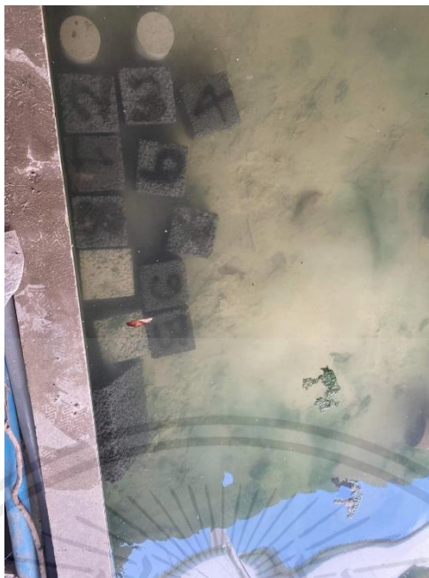
ภาพที่ 25 บ่มตัวอย่างคอนกรีตในน้ำ
