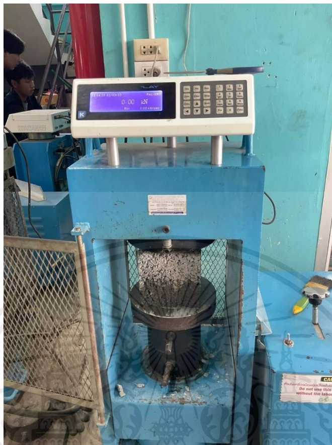
ภาพผนวกที่ ข3 การทดสอบกำลังรับแรงอัดของคอนกรีตพูน
