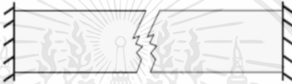
รูปที่ 2.1 การหดตัวแบบออโตจีนัสเนื่องจากเกิดหน่วยแรงดึงมากกว่ากำลังรับแรงดึงของคอนกรีต เมื่อมีการยัดรังคอนกรีต (CPAC หนังสือ Concrete Technology, 2000)
