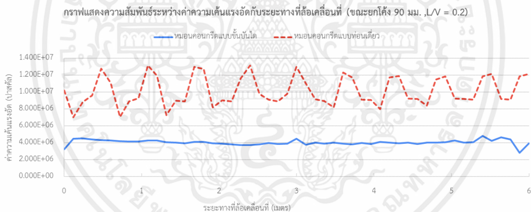
รูปที่ 4.20 กราฟแสดงความสัมพันธ์ระหว่างค่าความเค้นแรงอัดในแนวตั้งกับระยะทางที่ล้อเคลื่อนที่ (ขณะยกโค้ง 90 มิลลิเมตร L/V = 0.2)
