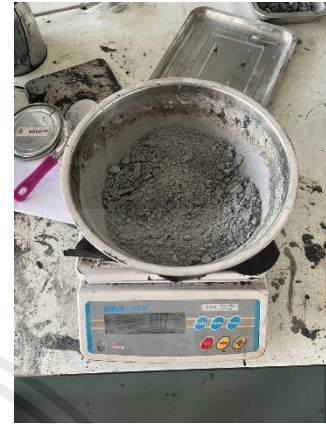
รูปที่ 3.4 มวลรวมที่นำไปอบเสร็จแล้ว
