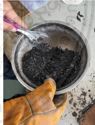
รูปที่ 3.5 การผสมแอสฟัลต์กับมวลรวม
