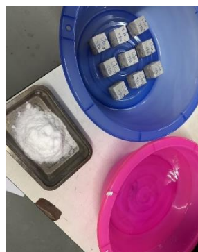
รูปที่ ฅ-14 เตรียมสารละลายแมกนีเซียมซัลเฟต
