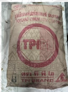
รูปที่ 3.1 ปูนซีเมนต์ปอร์ตแลนด์ประเภทที่ 1
