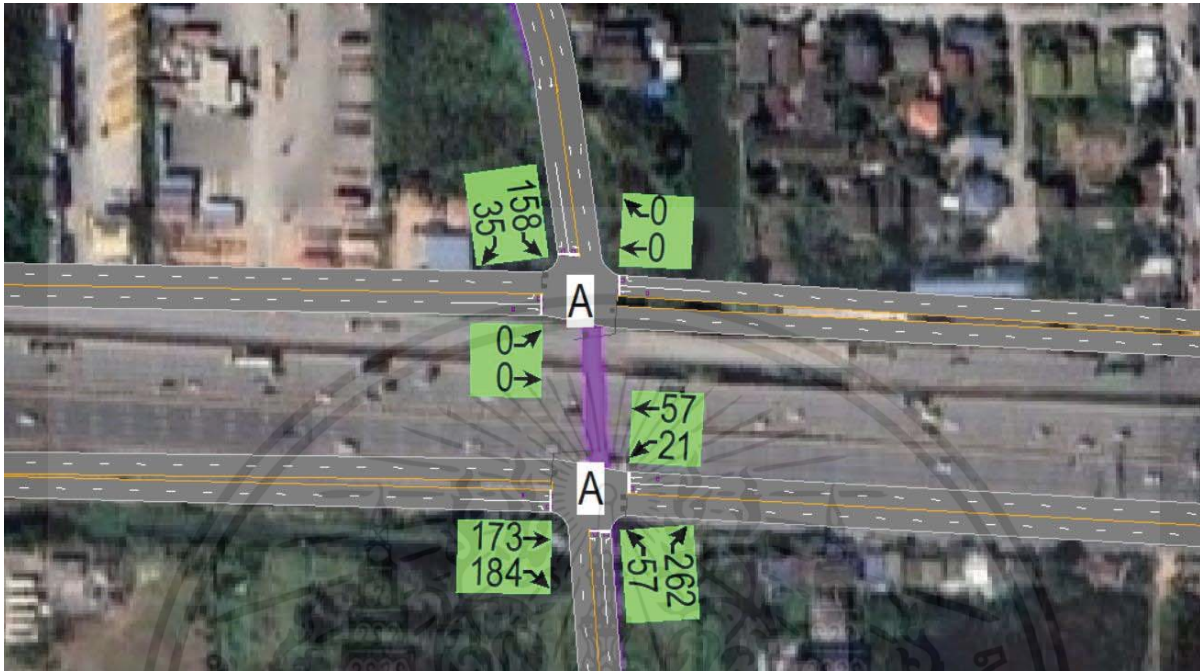
รูปที่ 4.8 ภาพแสดงระดับการให้บริการของทางแยกทางหลวงหมายเลข 3702 กม.14+000 ปีที่ 0
