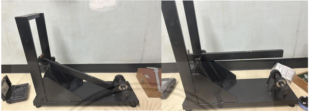
รูปที่ 3.17 คานก่อนติดตั้งและหลังติดตั้งตุ้มถ่วง
