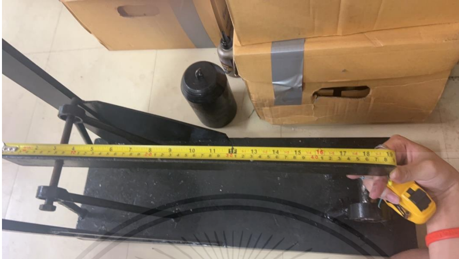
รูป ข.5 ตรวจสอบความยาวคาน เท่ากับ 49.00 เซนติเมตร ดังนั้นระยะจากปลายคานฝั่งเข้ารีบ เท่ากับ 49.00-7.00 เท่ากับ 42.00 เซนติเมตร
