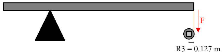
รูปที่ 3.5 แบบจำลองคานเพื่อคำนวณแรงที่กระทำกับเส้นเอ็นรับแรงดึง
