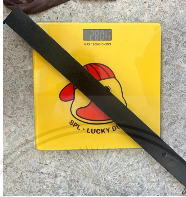
รูป ข.1 ตรวจสอบน้ำหนักคาน น้ำหนักคาน เท่ากับ 2.80 กิโลกรัม
