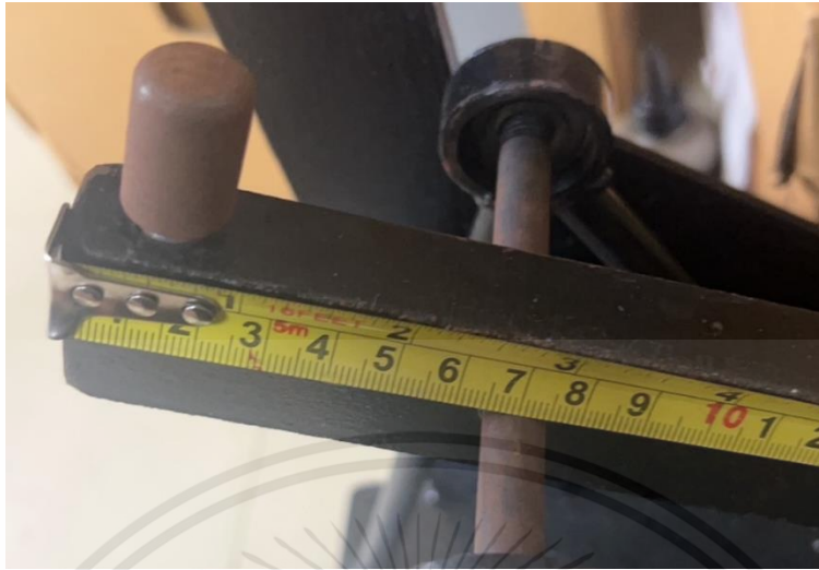
รูป ข.3 ตรวจสอบระยะจากปลายคานฝั่งวงแหวนถึงจุดหมุน เท่ากับ 7.00 เซนติเมตร
