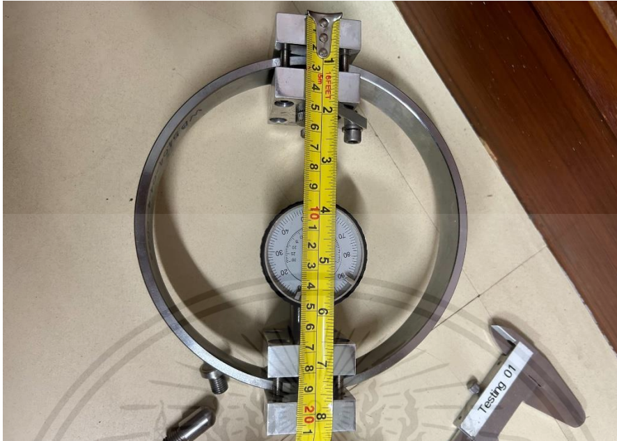
รูป ข.7 ตรวจสอบขนาดวงแหวนรับแรง ความสูงของวงแหวนมีขนาดเท่ากับ 20.90 เซนติเมตร
