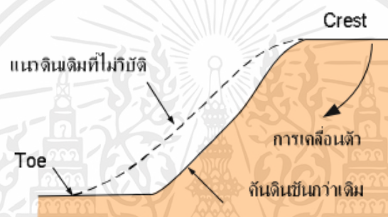
รูปที่ 2.7 คันดินที่มีความชันเพิ่มขึ้นจากลาดคันดินที่ถูกกัดเซาะโดยน้ำที่ไหลผ่านคันดิน ที่มา : จาก "วิศวกรรมฐานราก," โดย รศ.ดร. สุขสันต์ หอพิบูลสุข
