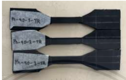
รูปที่ 3.10 ตัวอย่างทดสอบตามมาตรฐาน ASTM D6693
