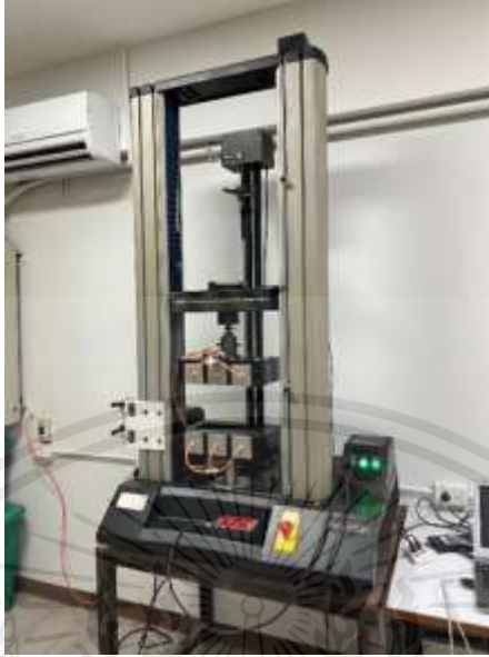
รูปที่ 3.13 เครื่องทดสอบความต้านทานการฉีกขาด
