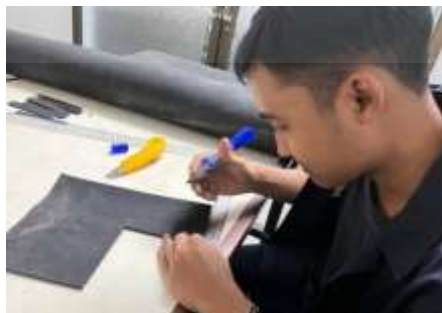
รูปที่ 3.9 วัดและตัดตามมาตรฐานการทดสอบแผ่นยางคอมปาวด์
