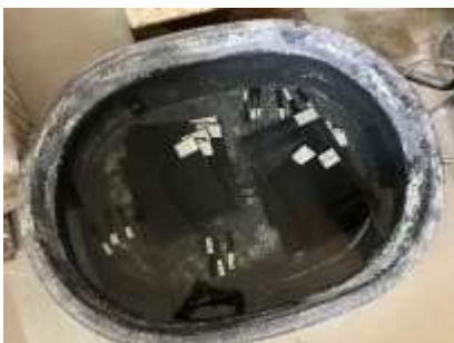
รูปที่ 3.4 การแช่ตัวอย่างทดสอบในกรดไนตริก ( \text{HNO}_3 )
