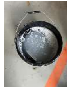
รูปที่ 3.5 การแช่ตัวอย่างทดสอบในเบส (ผงซักฟอก)
