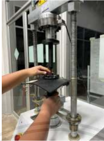
รูปที่ 3.20 นำหัวกดจากเครื่องทดสอบเลื่อนลงมาชิดกับผิวแผ่นยางคอมปาวด์
