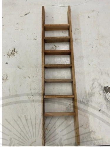
รูปที่ 3.5 แม่แบบขนาด 6.5x4x14 เซนติเมตร
