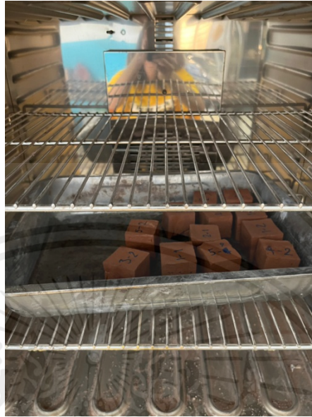
รูปที่ 3.31 นำอิฐไปอบ 50 องศาเซลเซียส เป็นเวลา 24 ชั่วโมง
