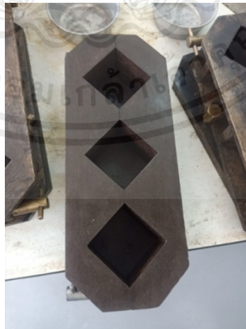
รูปที่ 3.4 แม่แบบขนาด 5x5x5 เซนติเมตร
