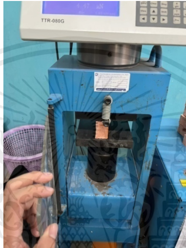
รูปที่ 3.27 การทดสอบกำลังรับแรงอัด
