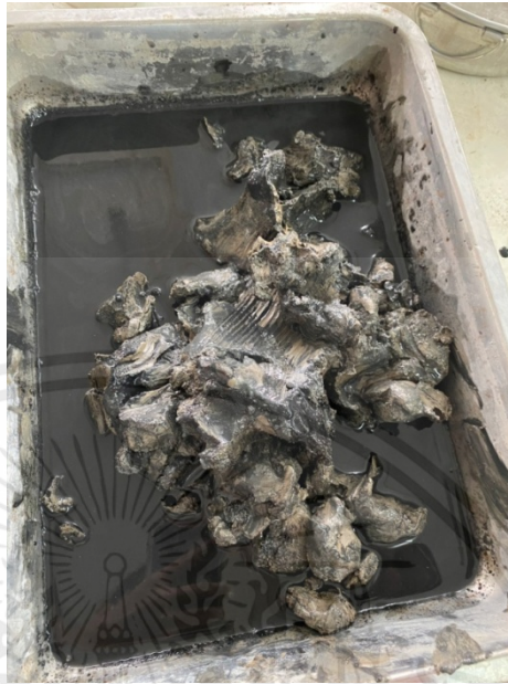
รูปที่ 3.21 ผสมดิน ทราय น้ำและไปโอซาร์ตามอัตราส่วนที่กำหนดไว้
