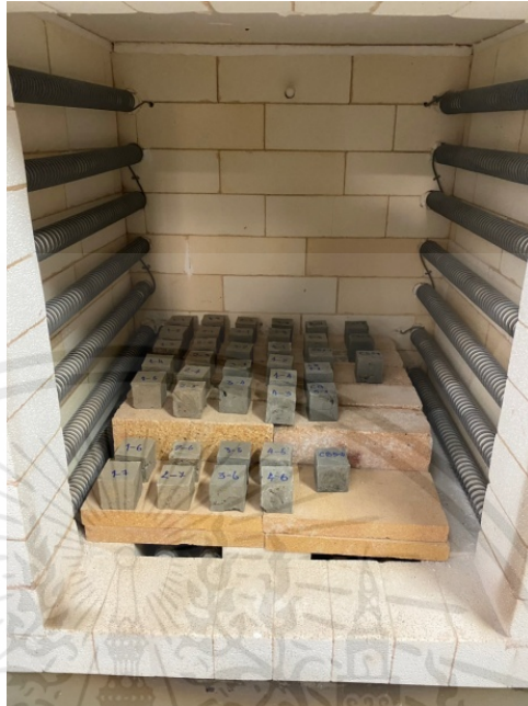
รูปที่ 3.25 นำอิฐไปใส่เตาเผา
