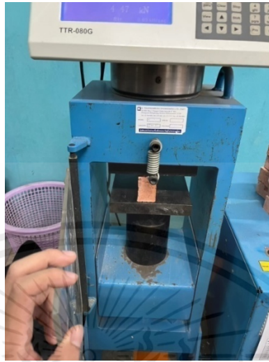
รูปที่ 3.1 เครื่องทดสอบกำลังอัด
