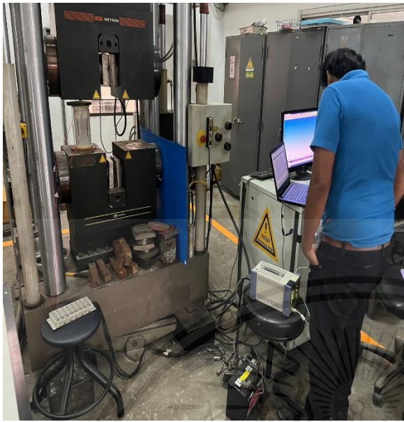
รูปที่ 3.11 ชุดอุปกรณ์การทดสอบโมดูลัสความยืดหยุ่น
