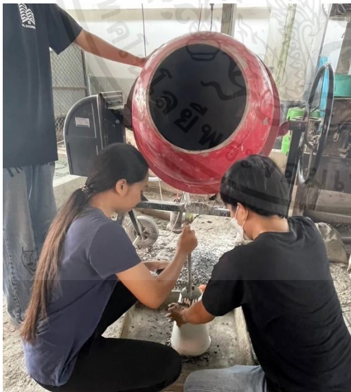
รูปที่ 3.7 กระทุ้งด้วยเหล็กกระทุ้งชั้นละ 25 ครั้ง
