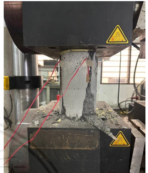
รูปที่ 3.12 ตัวอย่างคอนกรีตหลังได้โมดูลัสสูงสุด
