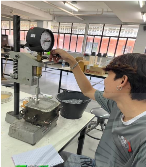
รูปที่ 3.5 การทดสอบหาระยะเวลาการก่อตัวของคอนกรีต
