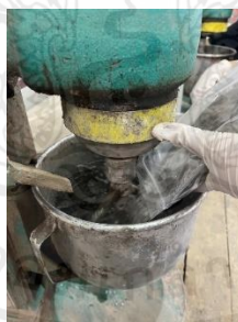
รูปที่ 3.14 โรยผงซีเมนต์ลงไปดินที่กำลังปั่นอยู่
