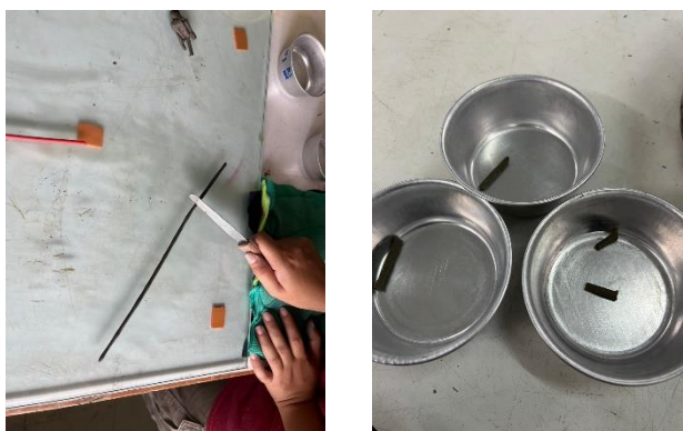
รูปที่ 3.10 การทดสอบหาค่าขีดจำกัดพลาสติก (PL)
