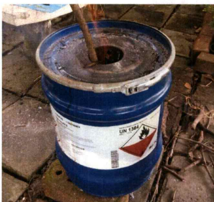
รูปที่ 3.2 เตาเผาสำหรับเผาถ่านชีวภาพ
