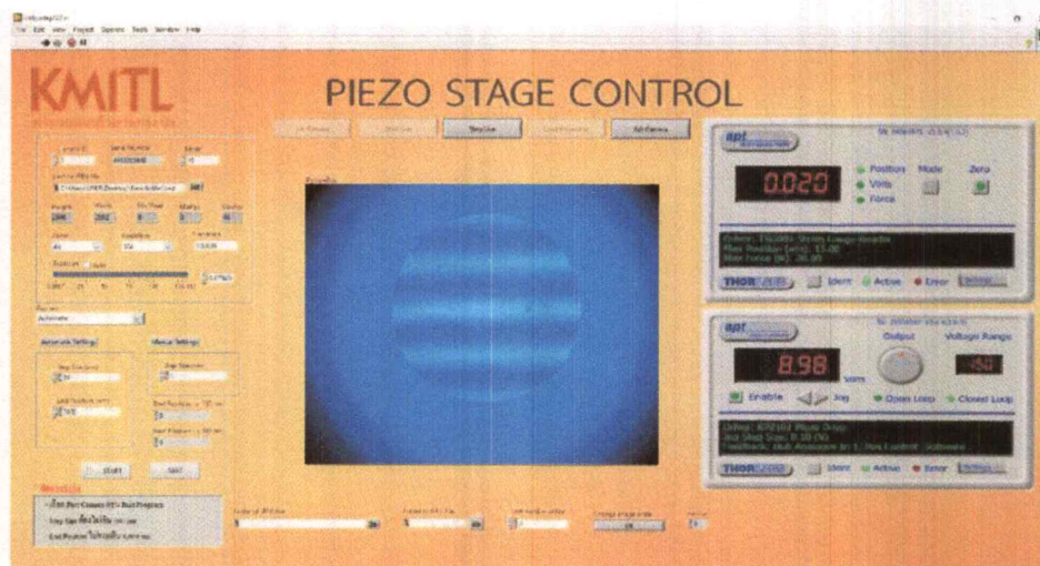
รูปที่ 4.3 Front Panel โปรแกรมที่ใช้ควบคุม Piezo Driver
