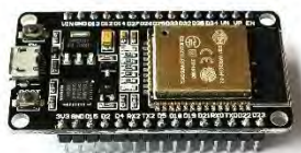
รูปที่ 2.13 Arduino ESP32 DOIT DEVKIT
