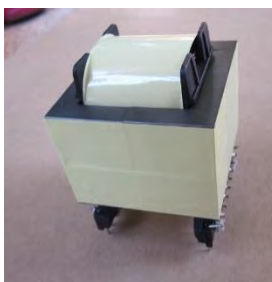
รูปที่ 2.30 หม้อแปลงชนิดแกนเฟอร์ไรท์
