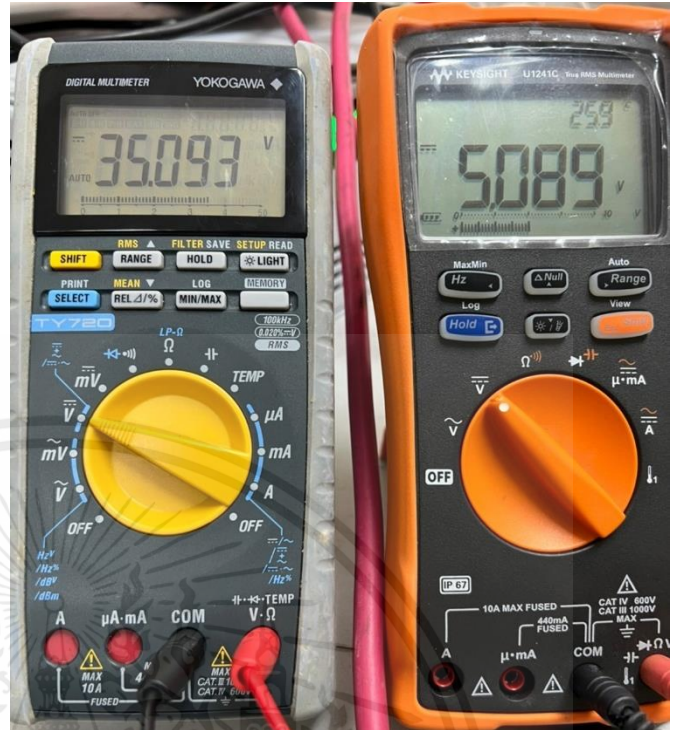
รูปที่ 4-4 ผลการทดลองจ่ายไฟที่35V
