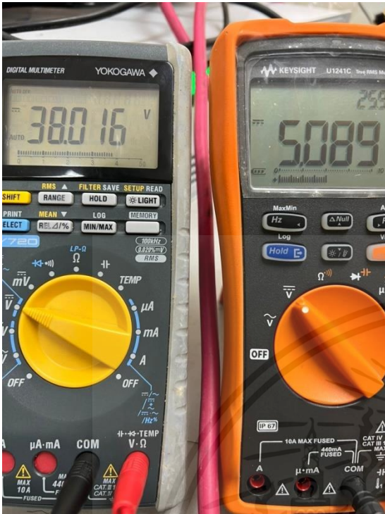
รูปที่ 4-3 ผลการทดลองจ่ายไฟที่38V
