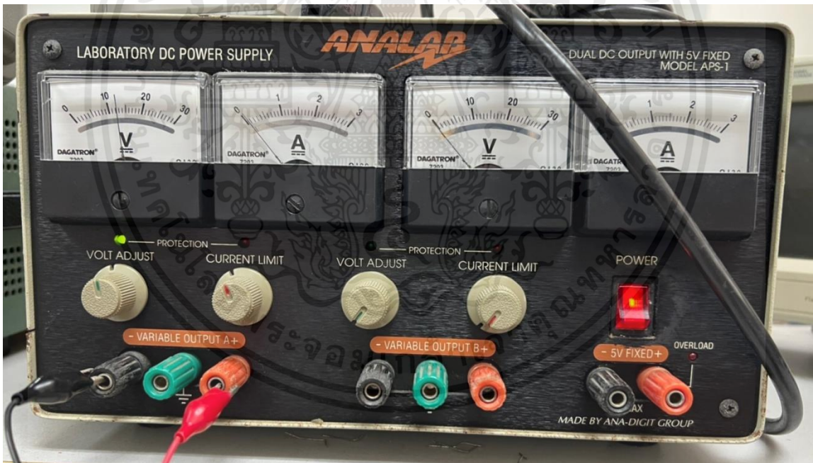
รูปที่ 3-37 ภาพตัวอย่างPower Supply ที่จ่ายเข้าสู่วงจรControl
