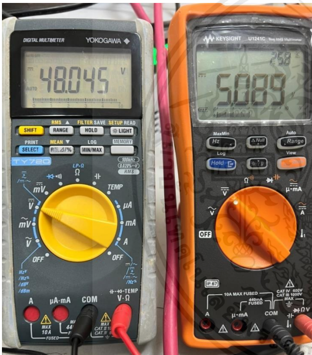
รูปที่ 4-1 ผลการทดลองจ่ายไฟที่ 48V
