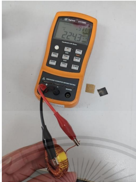
รูปที่ 3-21 ภาพตัวอย่างแกนเทอร์รอยหลังจากพันลวดทองแดงเสร็จเรียบร้อยแล้ว
