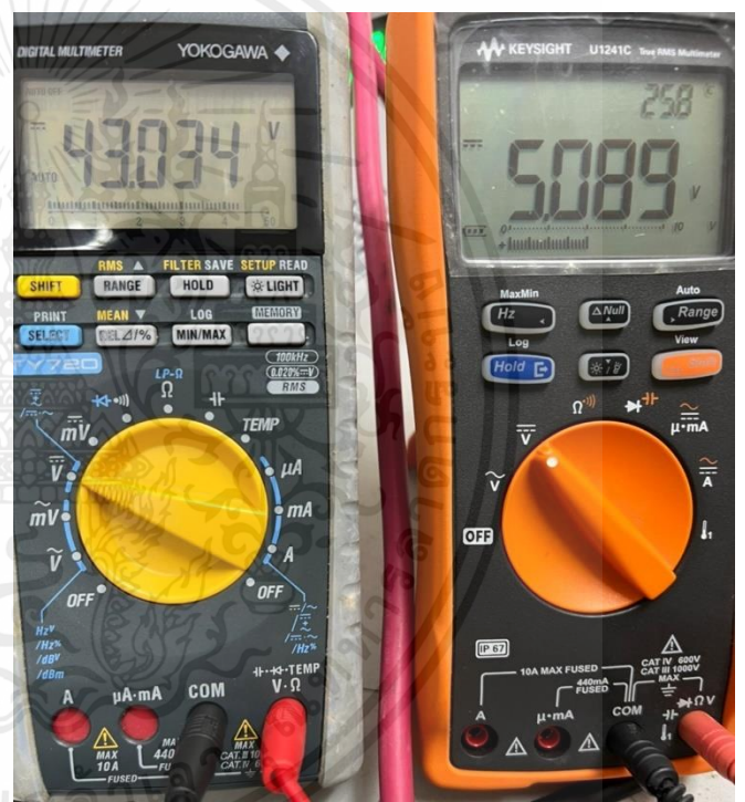
รูปที่ 4-2 ผลการทดลองจ่ายไฟที่ 43V
