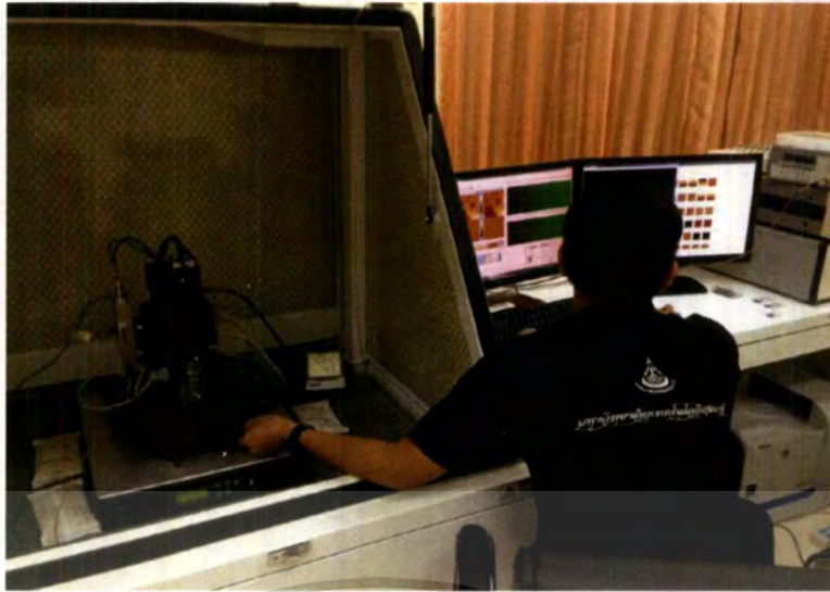
รูปที่ 3.15 กล้องจุลทรรศน์แบบแรงอะตอม Park Systems XE-120 ติดตั้งที่อาคารเครื่องมือ 10 ศูนย์เครื่องมือวิทยาศาสตร์และเทคโนโลยี มหาวิทยาลัยเทคโนโลยีสุรนารี
