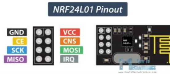
รูปที่ 2.14 ตำแหน่งของพินบนโมดูล nRF24L01
