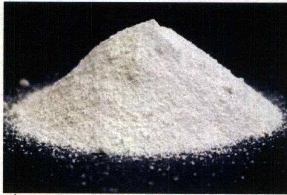
รูปที่ 2.1 ไทเทเนียมไดออกไซด์ ( TiO_2 ) (เคมีอุตสาหกรรม, 2560)
