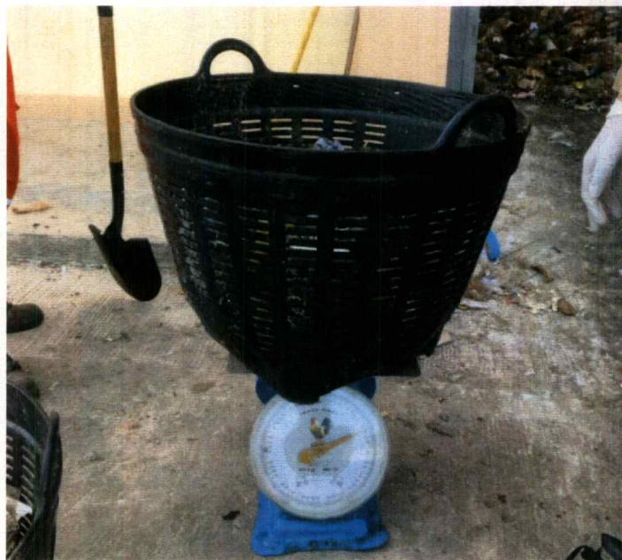
รูปที่ 3.19 ชั่งน้ำหนักขยะแต่ละองค์ประกอบ (Global Power Synergy Public Company Limited, 2561)
