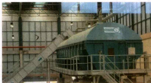
รูปที่ 3.3 เครื่องแยกขยะแบบกรงหมุน (Drum screen) (Global Power Synergy Public Company Limited, 2561)
