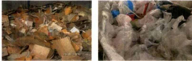
รูปที่ 3.12 แสดงตัวอย่างขยะที่ผ่านการคัดแยกและนำไปผลิตเป็นเชื้อเพลิง RDF (Global Power Synergy Public Company Limited, 2561)
