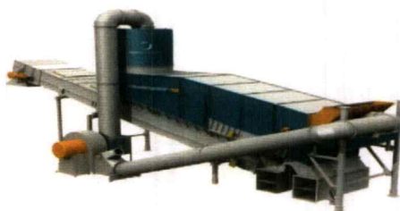
รูปที่ 3.11 เครื่องคัดแยกด้วยลม (Air-Classifier) (Global Power Synergy Public Company Limited, 2561)
