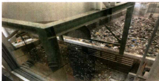
รูปที่ 3.4 ขยะอินทรีย์ที่ออกมาจากเครื่องแยกขยะแบบจานหมุน (Global Power Synergy Public Company Limited, 2561)
