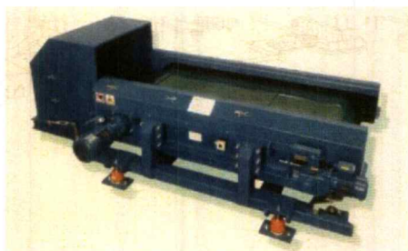
รูปที่ 3.10 เครื่องคัดแยกขยะด้วยกระแสไฟฟ้าเหนี่ยวนำ (Eddy Current Separator) (Global Power Synergy Public Company Limited, 2561)
