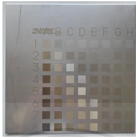
รูปที่ 3.18 รูปชิ้นงานจริงหลังจากทำการมาร์กด้วยเลเซอร์ ที่ความเร็ว 1500 มิลลิเมตรต่อวินาที
