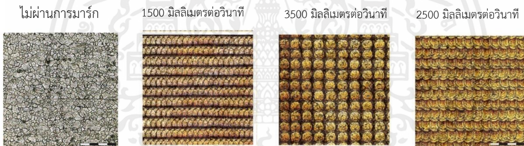
รูปที่ 4.14 รูปจากกล้องจุลทรรศน์สแกนด้วยเลเซอร์คอนโฟคอล ที่กำลังขยาย 20 เท่า ของชิ้นงานที่ไม่ผ่านการมาร์ก และชิ้นงานที่ความเร็ว 1500 3500 2500 มิลลิเมตรต่อวินาที ตามลำดับ
