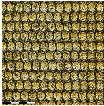
รูปที่ 2.12 แสดงภาพกำลังขยาย 20 เท่าของโลหะเหล็กกล้าไร้สนิมเกรด 316L จากกล้องจุลทรรศน์สแกนด้วยเลเซอร์คอนโฟคอล
