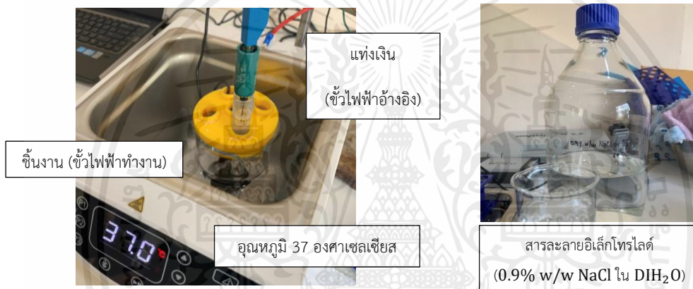
รูปที่ 3.24 แสดงการทดสอบการกัดกร่อนของชิ้นงานโดยวิธีศึกษาการทดสอบค่าศักย์ไฟฟ้าเริ่มต้น
