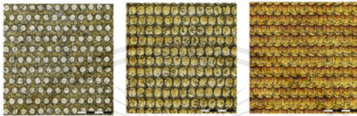
รูปที่ 4.15 แสดงผลกระทบของพลังงานกับขนาดของพื้นที่วงกลมบนรอยมาร์ค ที่ความถี่ 50 กิโลเฮิรตซ์ และค่าพลังงานที่ 20% 50% 80% ตามลำดับ
