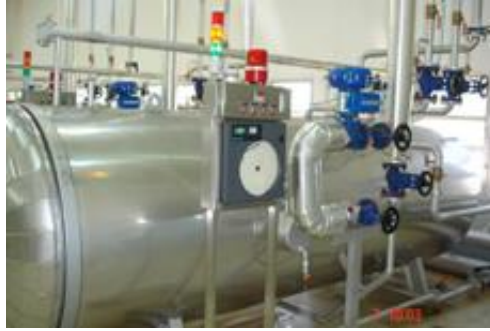
ภาพที่ 2.5 หม้อฆ่าเชื้อแบบใช้ไอน้ำอิมตัว
