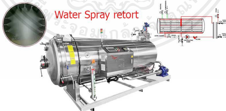
ภาพที่ 2.8 หม้อฆ่าเชื้อแบบใช้การพ่นน้ำร้อน
