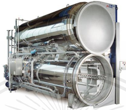
ภาพที่ 2.7 หม้อฆ่าเชื้อแบบใช้น้ำร้อนท่วม
