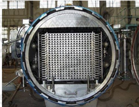
ภาพที่ 2.6 หม้อฆ่าเชื้อแบบใช้ไอน้ำผสมอากาศ
