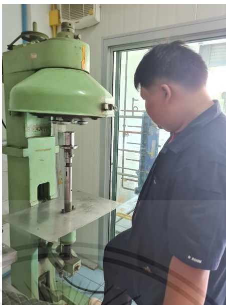
ภาพที่ 3.9 การปิดฝากระป๋องอาหารปั่นผสมสำหรับผู้สูงอายุ
