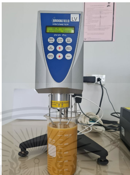
ภาพที่ 3.11 การวัดค่าความหนืด
