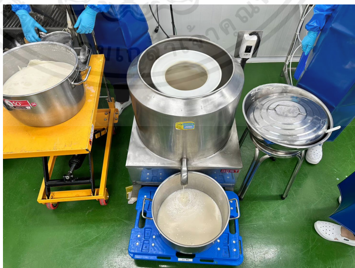
ภาพที่ 3.4 การกรองโดยใช้ถุงกรองความละเอียด 25 ไมครอน
