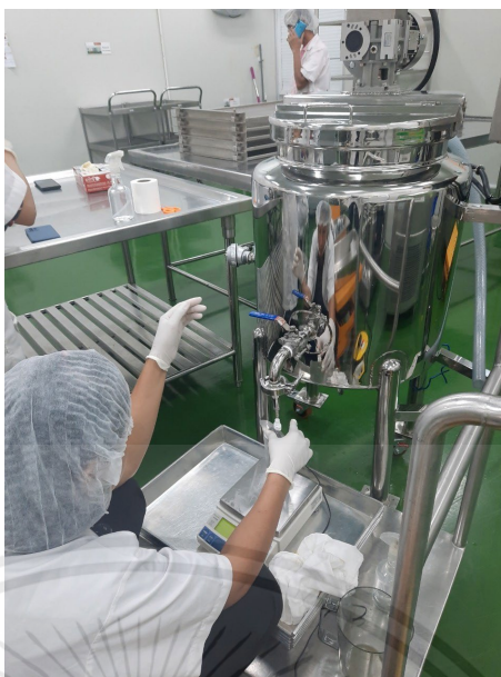
ภาพที่ 3.13 การบรรจุถุงแบบ hot fill
