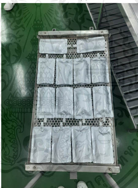
ภาพที่ 3.14 การเตรียมสำหรับการฆ่าเชื้อภายใต้แรงดัน
