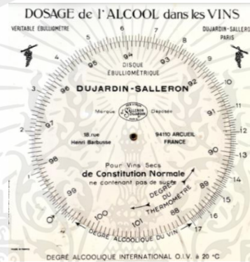
รูปที่ 2.8 แผ่นเทียบอุณหภูมิกับแอลกอฮอล์
