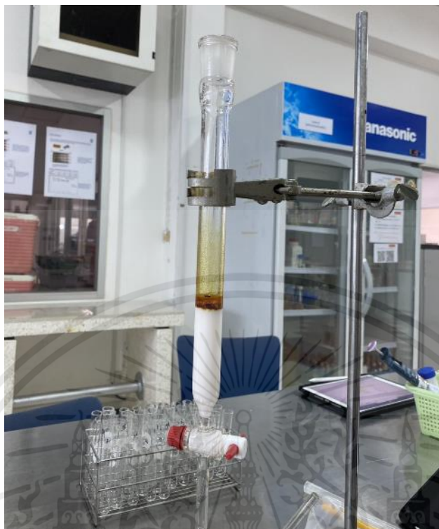
รูปที่ ก.5 การทดลองแยกสารบริสุทธิ์บางส่วนด้วยวิธีคอลัมน์โครมาโทกราฟี
