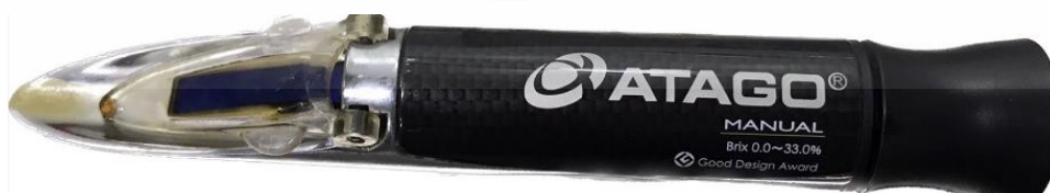
รูปที่ ก.8 การวิเคราะห์ค่า Brix ด้วยเครื่อง Refractometer (ATAGO, Japan)
